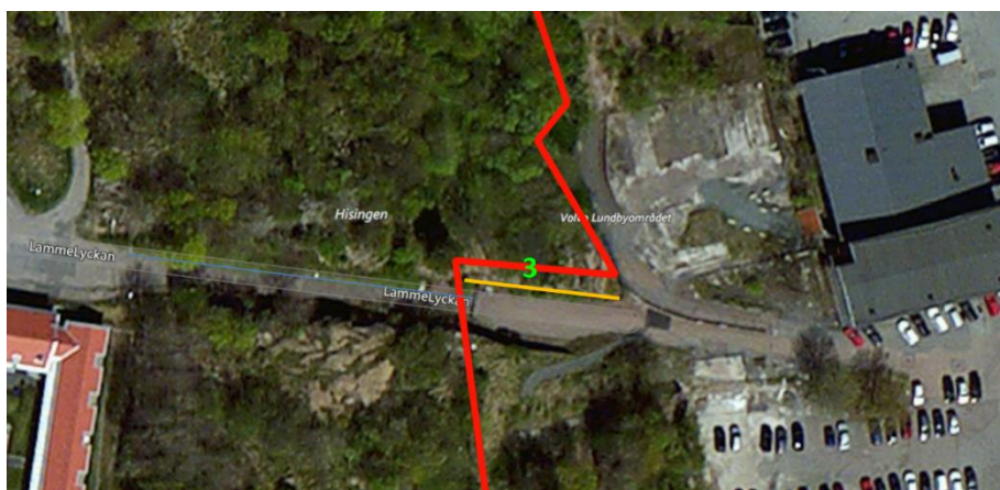
Figur 11. En tidigare schaktad slänt med risk för blocknedfall (orange linje).
